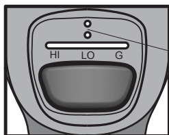
Témoin DEL de batterie faible (rouge – en haut) Témoin DEL du niveau de la charge (vert – en bas)
